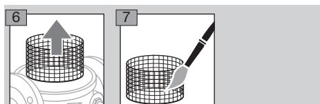
**8** После очистки сетчатого фильтра произведите сборку прибора в обратной последовательности.
