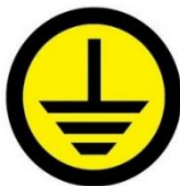
Рисунок 2 – Знак защитного заземления
