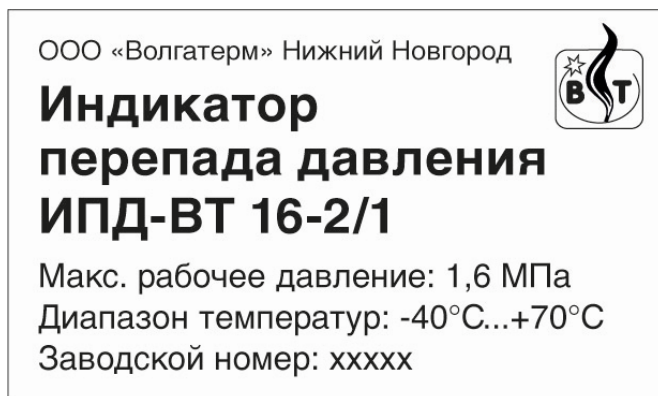
Рисунок 3 – Шильда индикатора перепада давления ИПД-ВТ 16-2/1
