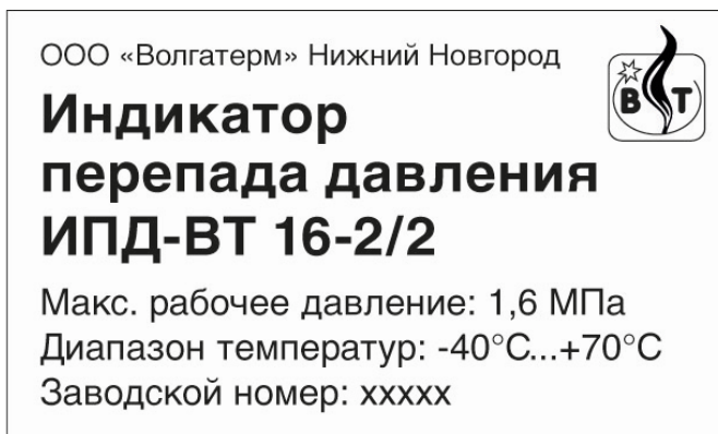
Рисунок 4 – Шильда индикатора перепада давления ИПД-ВТ 16-2/2
