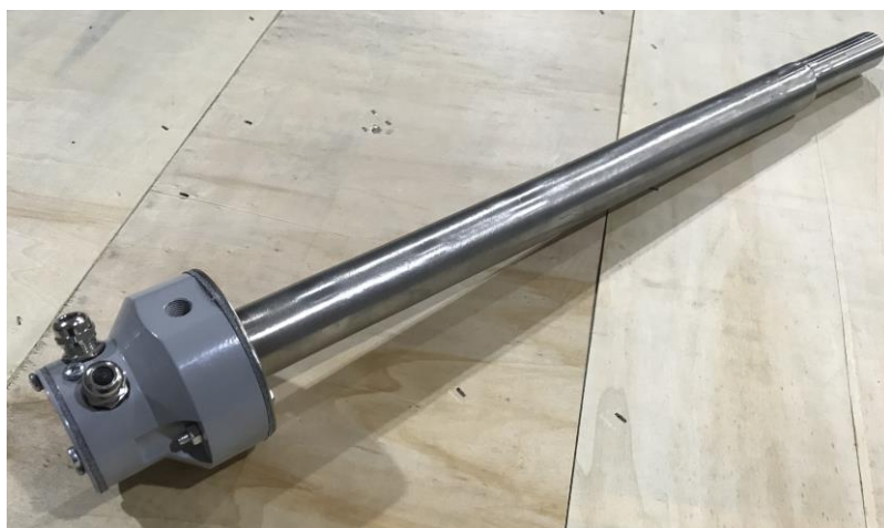
Рисунок 1 – Фото горелки ЗЗГ-ВТ 2
