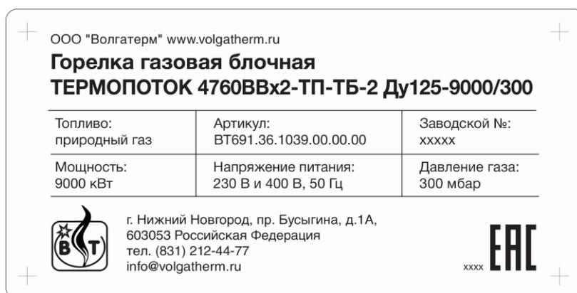
Рисунок 32 – Шильдик ГГБ сдвоенной ТЕРМОПОТОК 4760ВВх2-ТП-ТБ-2 Ду125-9000/300
