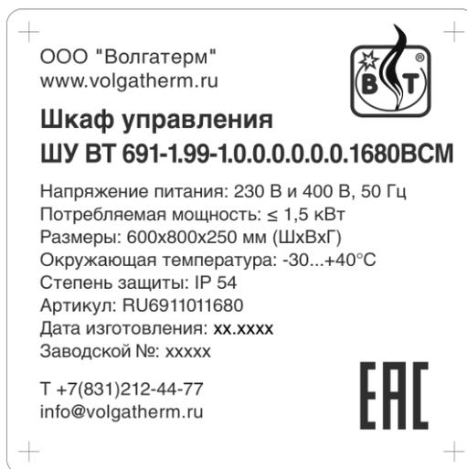
Рисунок 23 – Шильдик ШУ ВТ 691-1.99-1.0.0.0.0.0.1680ВСМ
