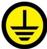
Рисунок 11 – Знак защитного заземления
