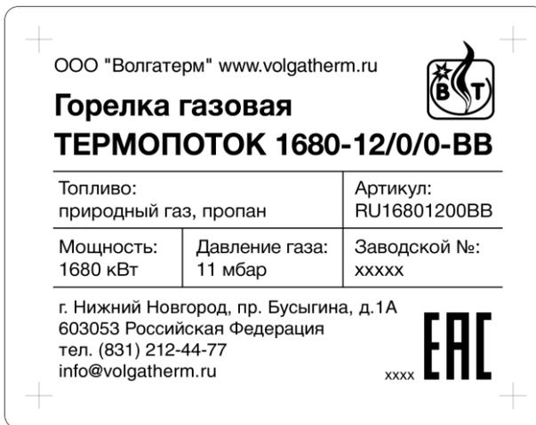
Рисунок 22 – Шильдик базовой горелки газовой ТЕРМОПОТОК 1680-12/0/0BB
