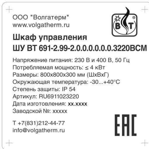
Рисунок 31 – Шильдик ШУ ВТ 691-2.99-2.0.0.0.0.0.3220ВСМ
