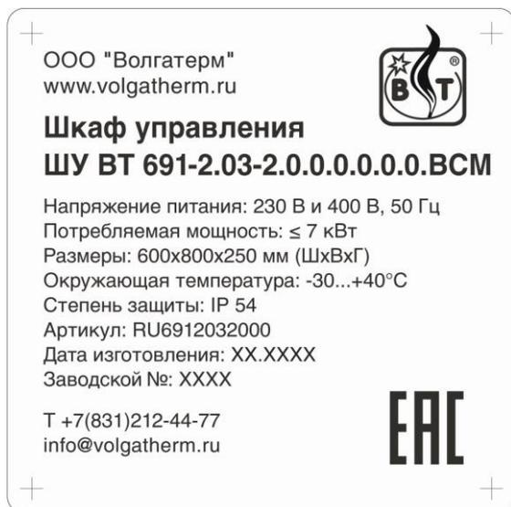
Рисунок 19 – Шильдик ШУ ВТ 691-2.03-2.0.0.0.0.0.0.ВСМ
