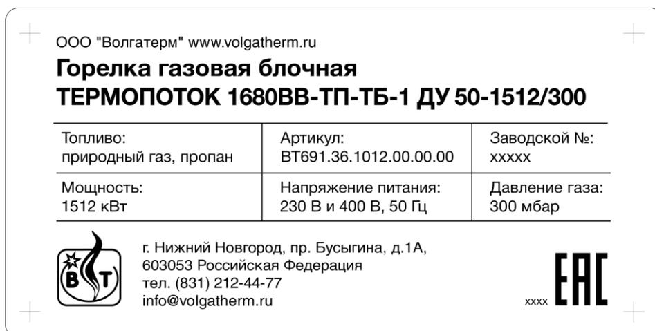
Рисунок 21 – Шильдик ГГБ ТЕРМОПОТОК 1680ВВ-ТП-ТБ-1 ДУ 50-1512/300
