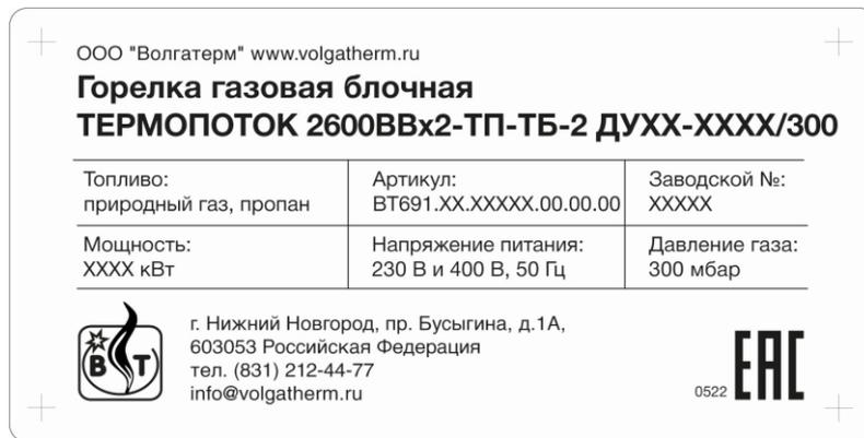
Рисунок 17 – Шильдик ГГБ ТЕРМОПОТОК 2600ВВх2-ТП-ТБ-2 ДУХХ-ХХХХ/300
