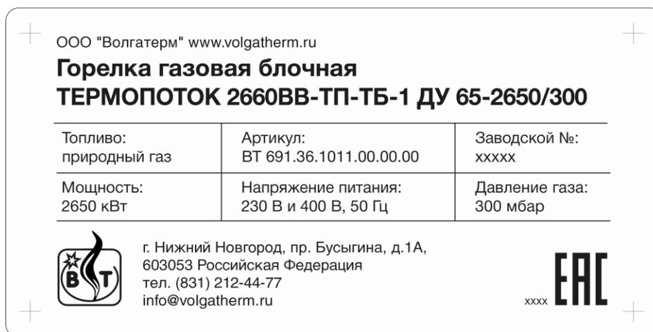
Рисунок 24 – Шильдик ГГБ ТЕРМОПОТОК 2660BB-ТП-ТБ-1 ДУ 65-2650/300
