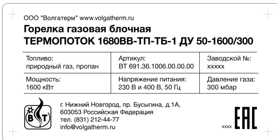
Рисунок 20 – Шильдик ГГБ ТЕРМОПОТОК 1680ВВ-ТП-ТБ-1 ДУ 50-1600/300
