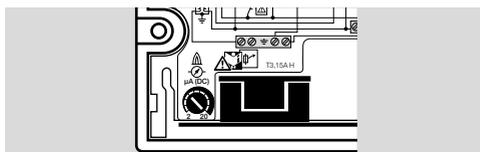
→ Предохранитель защищает только выход запального трансформатора! После короткого замыкания на выходе клапана сработал внутренний предохранитель, который нельзя заменить. Отправьте прибор на проверку изготовителю.
