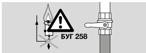
→ Если переключатель установлен на повторный пуск, БУГ 258 сначала повторно запускается и затем производит аварийное отключение. При аварийном отключении газовые клапаны обесточиваются. Контакт аварийной сигнализации между клеммами **8** и **9** замыкается. Дисплей мигает и отображает текущее состояние программы.
